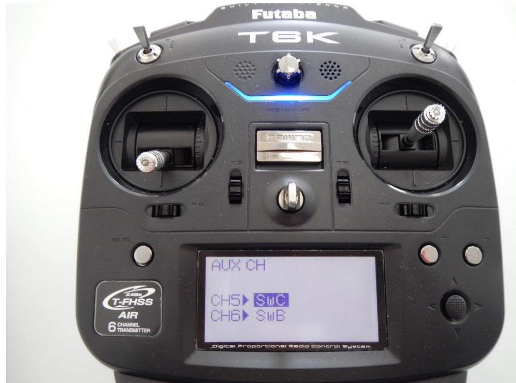
Questo ci serve per abilitare lo Switch C sulla radio in modo tale che sia abbinato al canale 5 della ricevente che in fase di assemblaggio del drone abbiamo collegato al NAZA e che ci permette di cambiare la modalità di volo.
