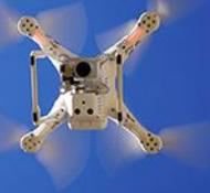
Misurare la distanza del centro del GPS rispetto al centro di gravità del drone.
