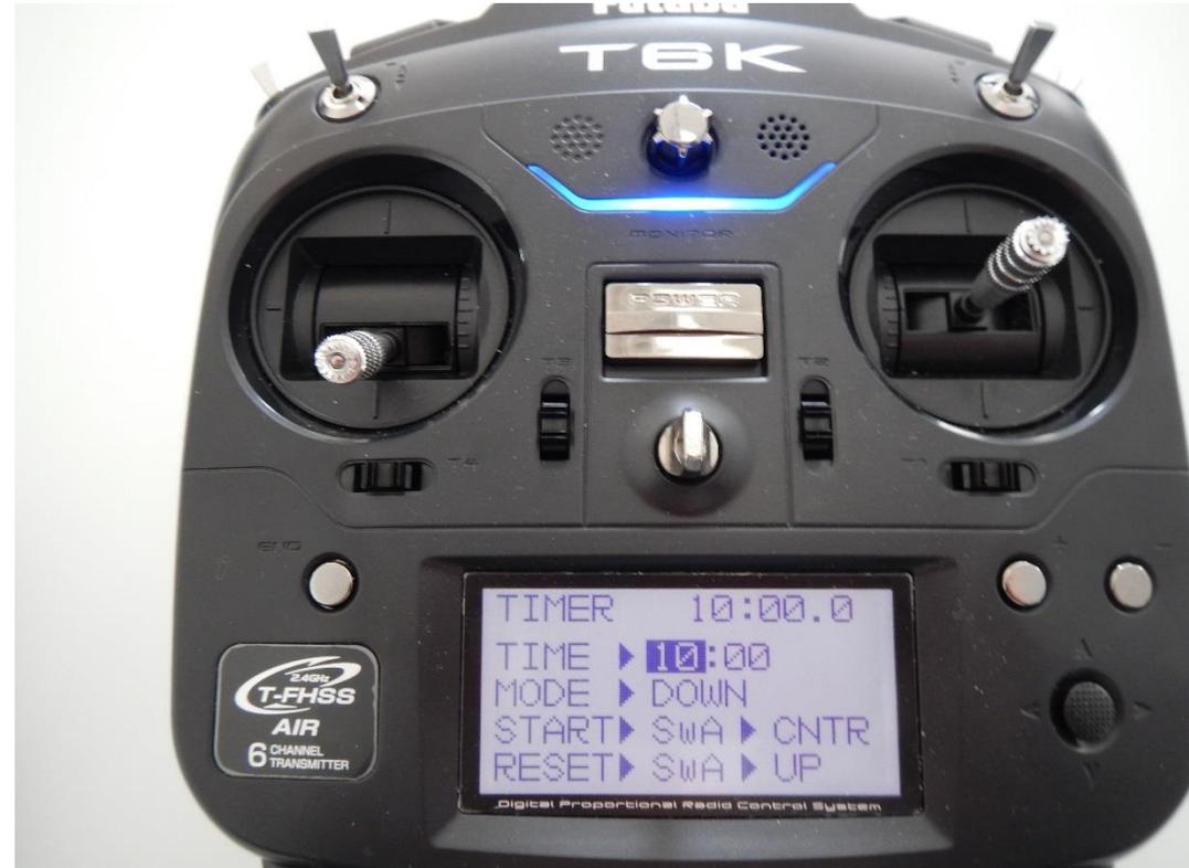
Questo ci serve per abbinare il Timer con conto alla rovescia di 10 minuti allo Switch A sulla radio
